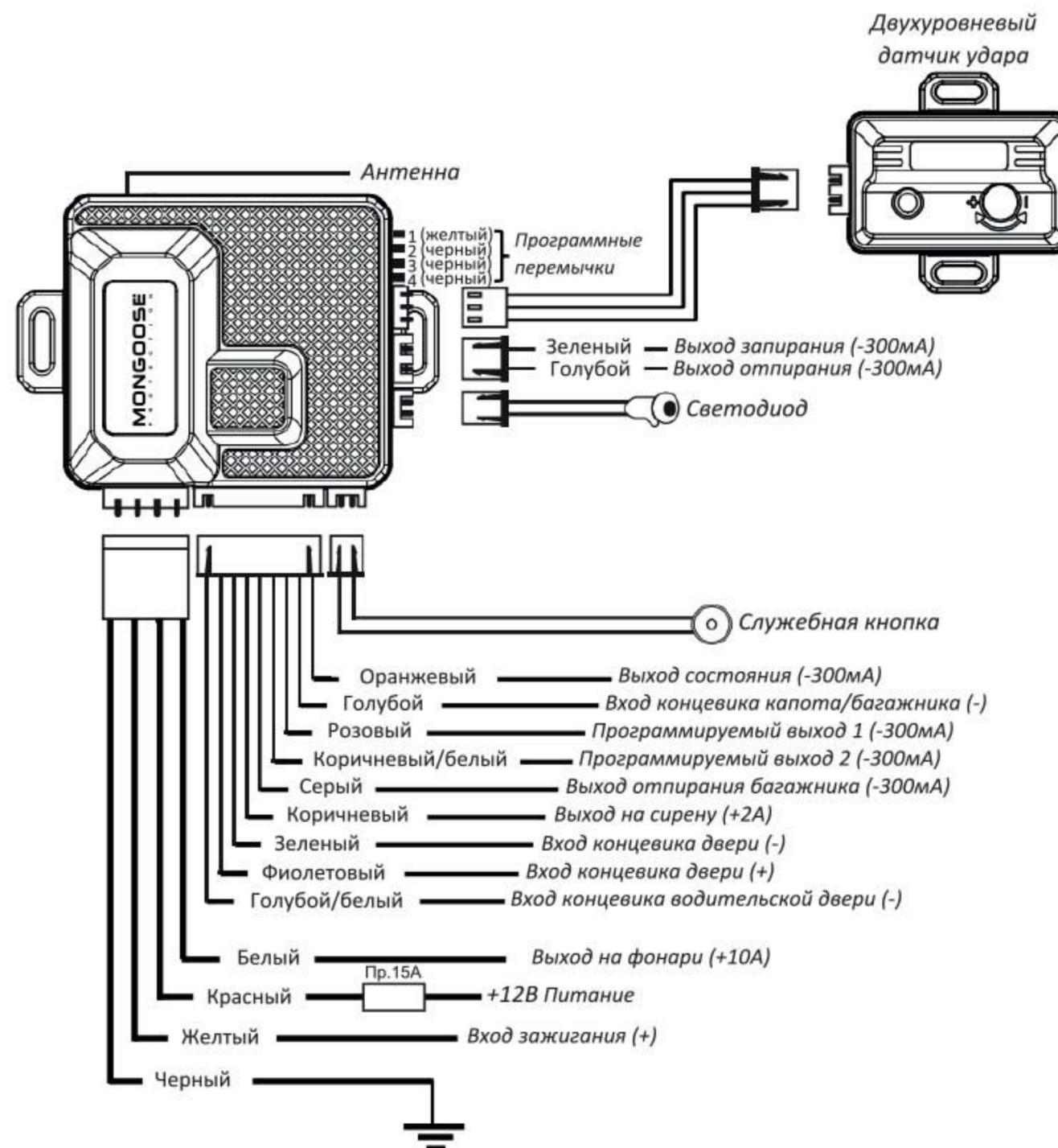
**Назначение проводов и разъемов центрального блока.**
