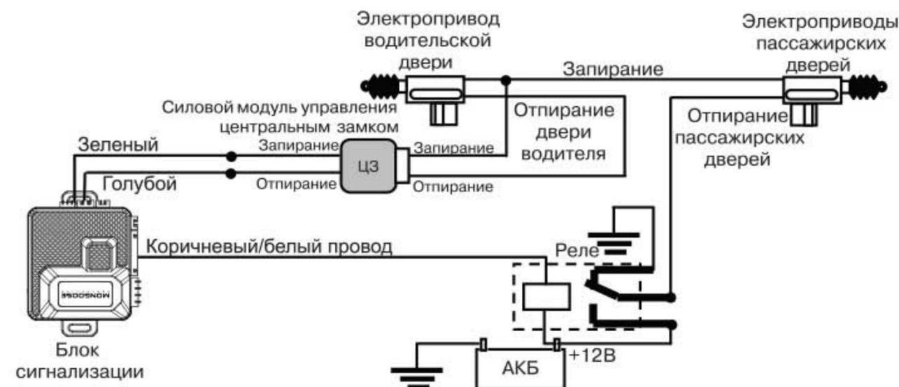
**Подключение программируемого выхода 1 для реализации функции "Турбо таймер" (см. Программируемую функцию 21)**
