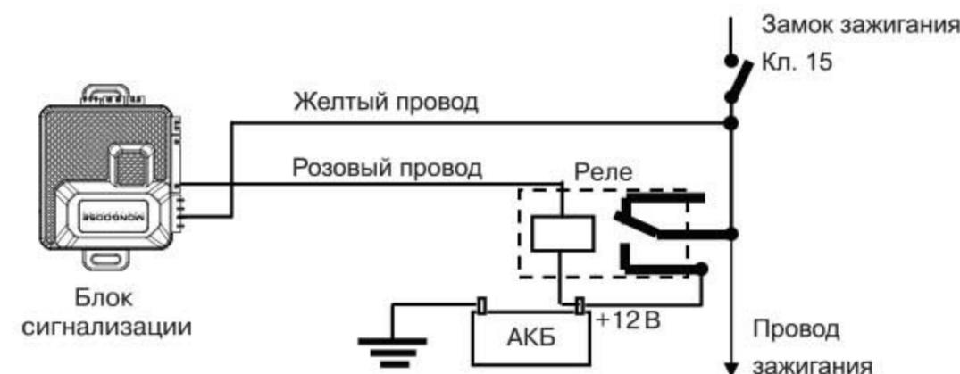
**Подключение дополнительных каналов**
