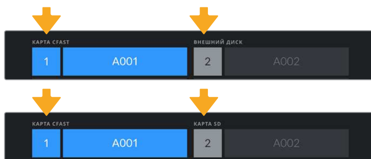
Панель параметров сохранения на камере показывает, какой носитель (CFast, SD или флеш-накопитель USB-C) используется в настоящий момент
