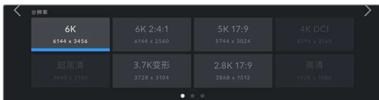
使用Blackmagic RAW编解码格式时，Pocket Cinema Camera 6K的“分辨率”选项
