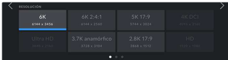
Opciones RESOLUCIÓN al grabar en Blackmagic RAW en el modelo Blackmagic Pocket Cinema Camera 6K
